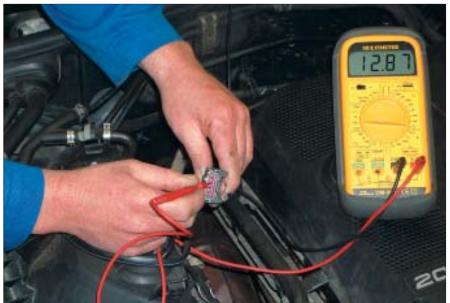
Måling uden adapterkabel
