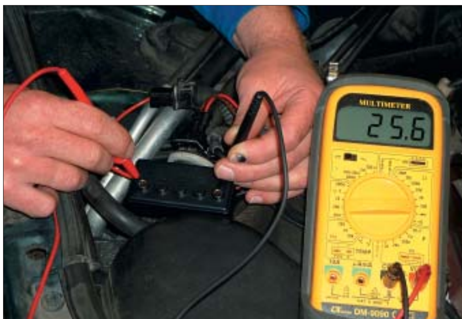
Måling med adapterkabel
