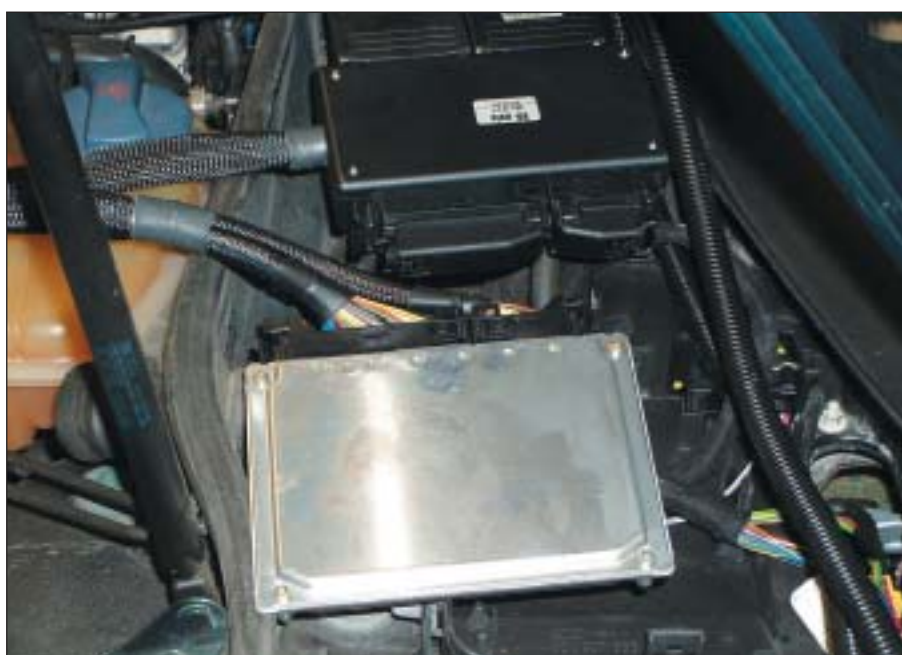
Tilslutning parallel diagnose
