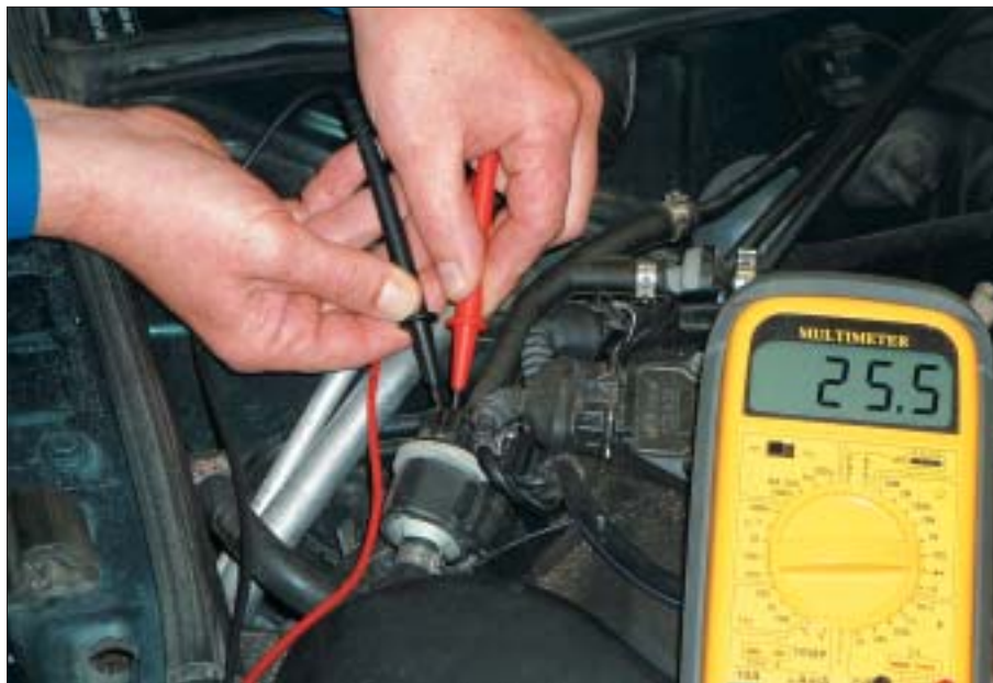
Måling uden adapterkabel
