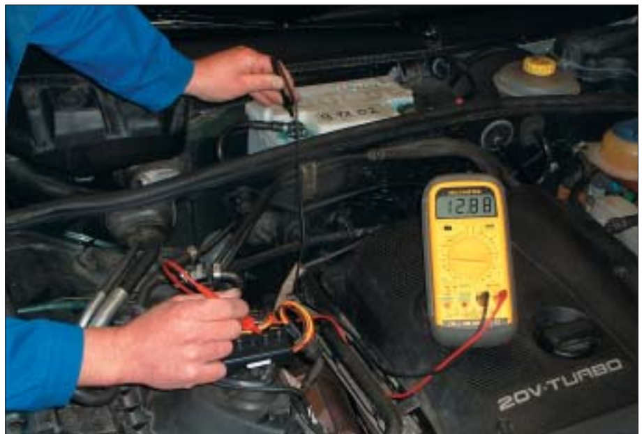
Måling med adapterkabel
