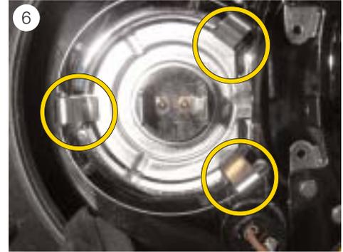
Lorsque le projecteur est déposé, la plaque d'arrêt est facilement visible (voir fig. 4). Côté conducteur, un long tournevis ou un outil similaire est nécessaire pour atteindre le levier.
