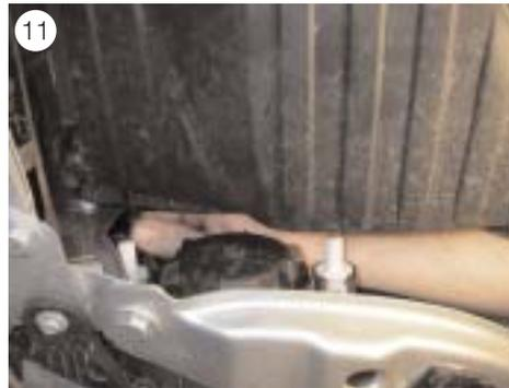
Prendre la canalisation d'air d'admission par les trous oblongs puis la sortir du boîtier de filtre à air (voir fig. 10).
