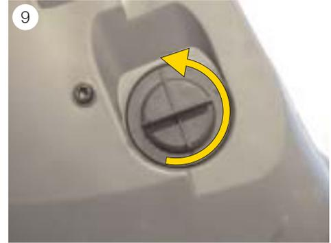
■ Tourner la douille de la lampe du feu clignotant dans le sens inverse des aiguilles d'une montre, jusqu'en butée, et l'extraire du projecteur avec la lampe (voir fig. 9).
