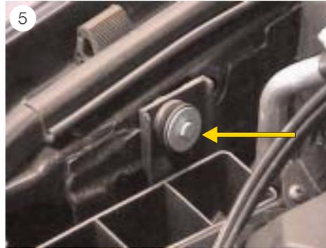
■ Déposer la vis de fixation du boîtier du filtre à air (voir fig. 5).
