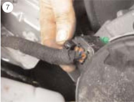
■ Détacher la connexion et débrancher le connecteur du projecteur (voir fig. 7).
