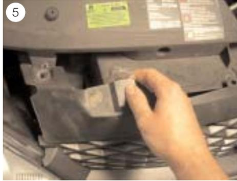
■ Desserrer les vis de la calandre en plastique et déposer celle-ci (voir fig. 5).
