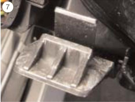
Remonter toutes les pièces déposées dans l'ordre inverse. Lors de la remise en place du projecteur, il faut veiller à ce que les deux fixations inférieures du projecteur (voir fig. 7) se réenclenchent correctement sur la carrosserie.
