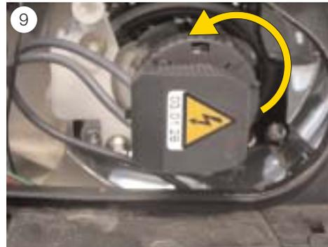
■ Tourner le connecteur haute tension (douille) dans le sens inverse des aiguilles d'une montre et le séparer de la lampe au xénon (voir fig. 9).
