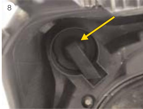
■ Déposer le cache en caoutchouc du feu de position, extraire du réflecteur la douille avec la lampe et remplacer la lampe (voir fig. 8).
