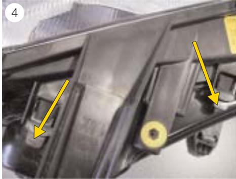
■ Pousser les nez d'encliquetage du cache de protection du projecteur, sur les faces supérieure et inférieure du projecteur, hors des fixations et déposer le cache (voir fig. 4 et 5).
