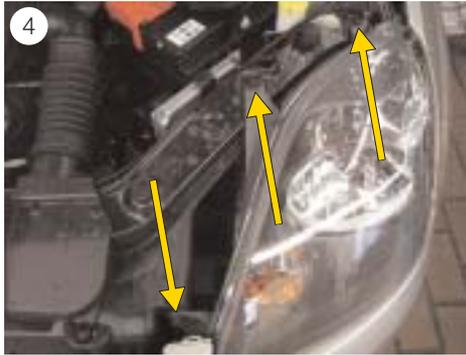
■ Desserrer les vis de fixation (Torx 30) du projecteur (voir fig. 4).
